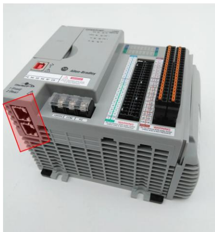
RYSUNEK 1.15. Dwa sterowniki PLC różnych producentów z interfejsami Ethernet (czerwona ramka) [G1]
