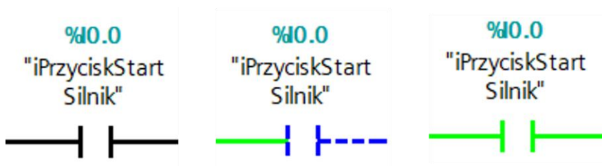
RYSUNEK 6.5. Od lewej — styk NO w programie offline, stan niski w podglądzie online oraz stan wysoki w podglądzie online
