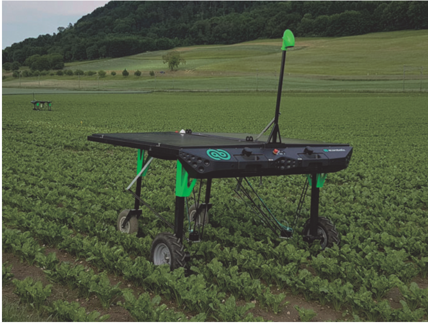
Rysunek 1.4. Autonomiczny robot mobilny do pielienia chwastów (dzięki uprzejmości firmy Ecorobotix)
