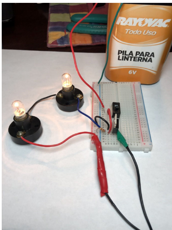
Rysunek 9.12. Obwód z tranzystorem i przełącznikiem
