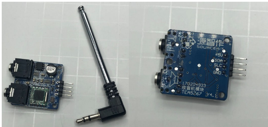
Rysunek 18.7. Moduł radio FM oparty na układzie TEA5767
