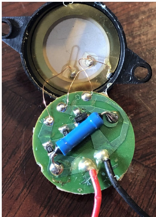
Rysunek 12.2. Wnętrze brzęczyka piezoelektrycznego
