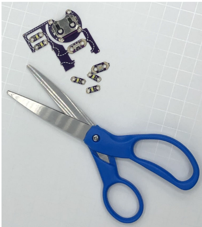
Rysunek 20.4. Oddzielanie płytek z diodami LED
