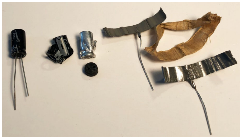
Rysunek 10.1. W środku kondensatora
