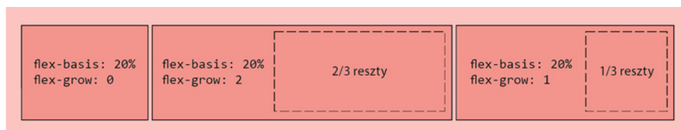
Rysunek 5.10. Elementy z większą wartością właściwości flex-grow zajmują większą część pozostałej dostępnej szerokości
