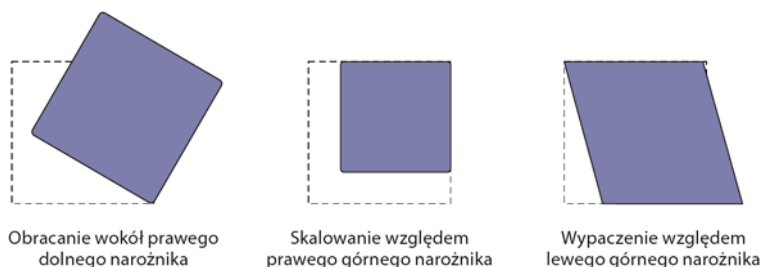
Rysunek 15.4. Obracanie, skalowanie i wypaczenie dokonywane względem punktu źródłowego transformacji znajdującego się w różnych narożnikach elementu
