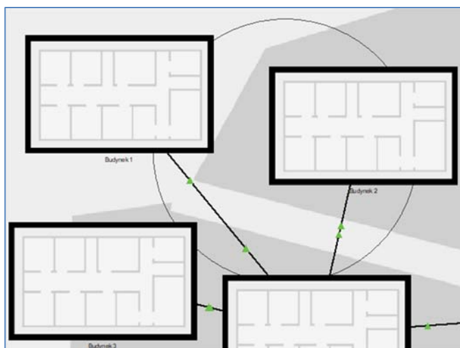
Rysunek 10.15 Okrąg pokazujący zasięg sieci bezprzewodowej
