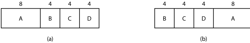
Rysunek 2.18. Przykład algorytmu szeregowania: najpierw krótsze zadania; (a) uruchamianie zadań w kolejności pierwotnej; (b) uruchamianie zadań według zasady „najpierw krótsze zadanie”
