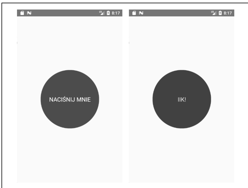
Rysunek 4.2. Zastosowanie <TouchableHighlight> do stworzenia interaktywnego wyglądu — stan przed naciśnięciem (po lewej) i podświetlony po naciśnięciu (po prawej)
