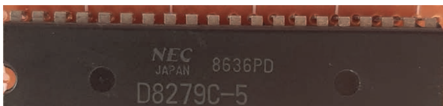
Rysunek 1.7. Żeby wylutować taką „stonogę”, trzeba jednocześnie podgrzać wszystkie wyprowadzenia
