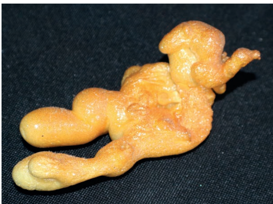
B Rozdęta i wyschnięta pianka dwuskładnikowa
