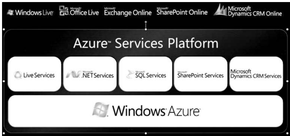
Rysunek 2.6. Architektura i framework Windows Azure. Na najniższym poziomie działa system operacyjny Azure. Jest on uruchamiany w wirtualnym środowisku stworzonym przez monitor Microsoft Hypervisor na czystym sprzęcie. W najwyższej warstwie działają aplikacje przeznaczone dla użytkowników końcowych, które Microsoft przekształca do postaci SaaS. Źródło: Microsoft
