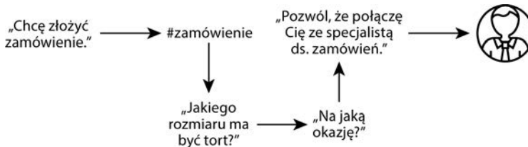
Rysunek 2.14. Przekształcanie agenta kierującego w bota zorientowanego na proces. Teraz, przed przekazaniem obsługi zamówienia do człowieka, bot zbiera dwie informacje
