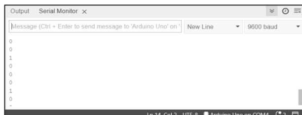
Rysunek 3.4. Zewnętrzne pole elektromagnetyczne powoduje indukowanie napięć rozpoznawanych błędnie jako stan wysoki (wtedy mikrokontroler odczytuje, że na wejściu 5. jest wartość 1)
