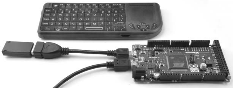
Rysunek 11.5. Klawiatura podłączona do Arduino Due za pomocą kabla Micro USB OTG Host
