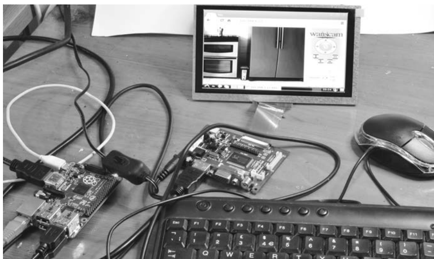
Rysunek 5.3. System komputerowy oparty na Raspberry Pi
