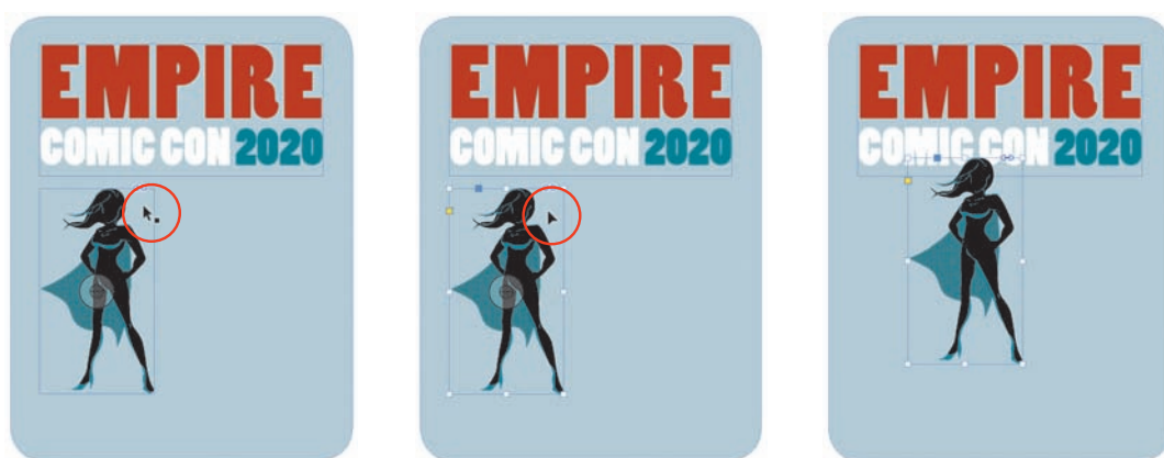
Rysunek 1.7. Zaznaczenie (z lewej) i przesuwanie obiektu narzędziem Selection (Zaznaczanie)
